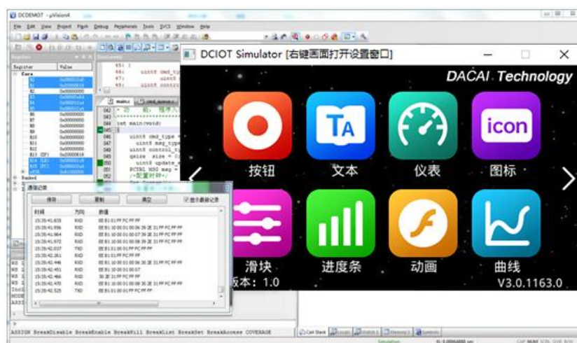
图 11-3 Keil 开发环境与虚拟串口屏绑定调试
